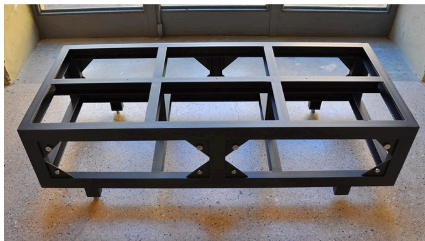
fig. 14 La struttura della base, poi rivestita di lamiere fissate con magneti.
