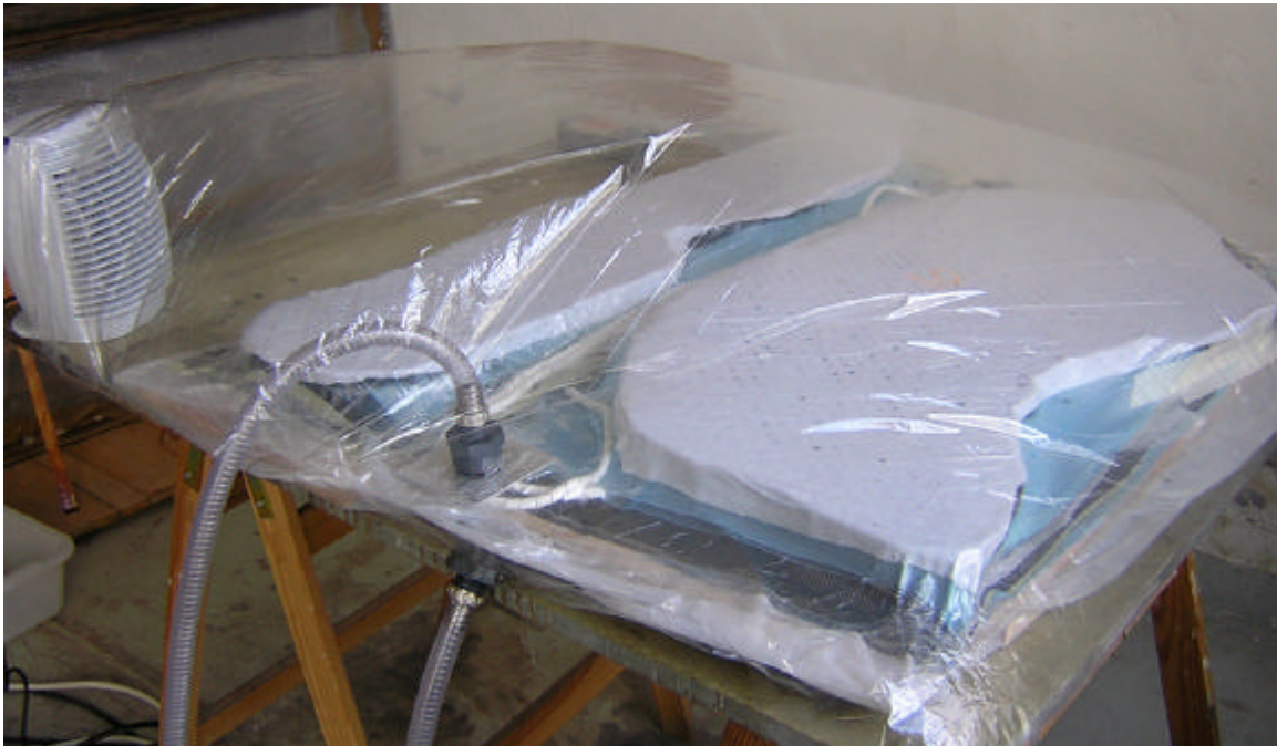
Il "forno" per il completamento della reticolazione della resina
