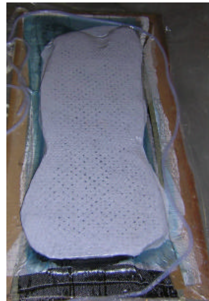
Laminazione della seconda pelle di Carbonio in cui si evidenziano gli strati drenanti
