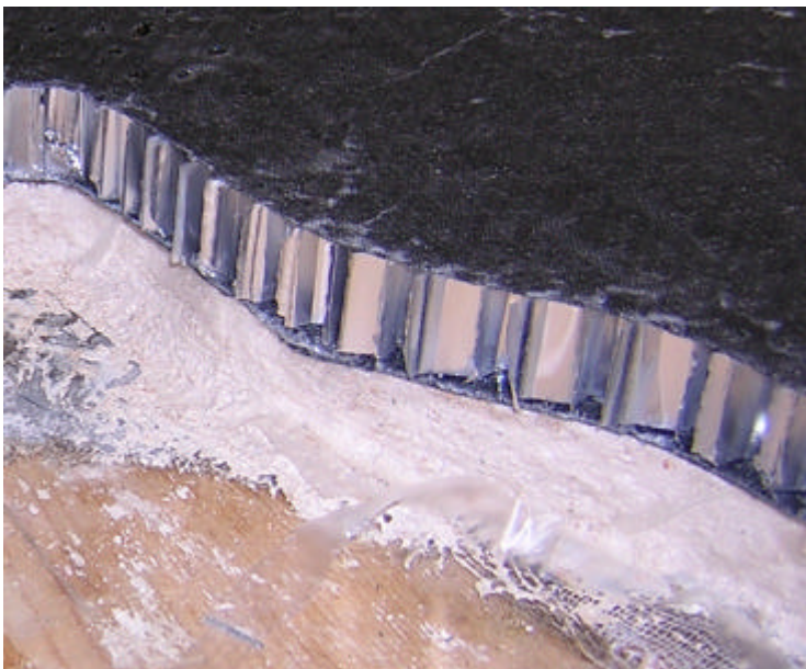
Sezione del pannello in cui sono visibili le celle del nido d'ape d'alluminio tra le due pelli di Carbonio
