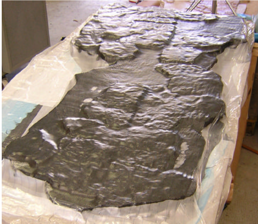
Laminazione della prima pelle di Carbonio sul retro del mosaico
